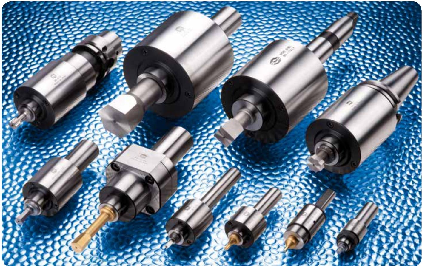
**I** Il Brocciatore è un attrezzo per l'esecuzione rapida di cave poligonali a sezione regolare (quadra, esagonale, TORX®, dentata, scanalata ecc.) in fori ciechi o passanti. Inoltre, con l'ausilio dell'adattatore, sullo stesso brocciatore si possono realizzare profili esterni a sezione regolare.
